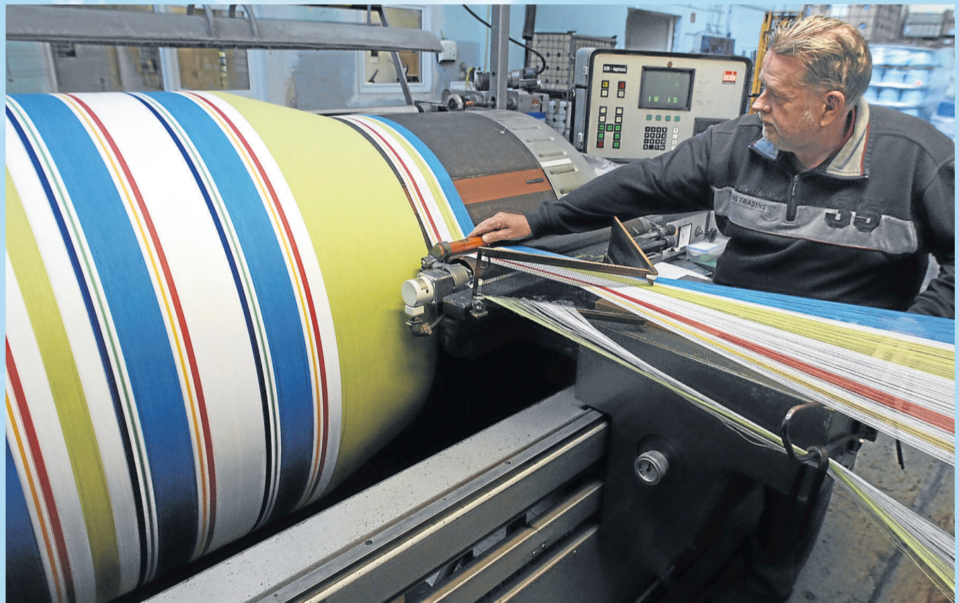
Kettstellung im Vorwerk: Hier werden die Farben gebäumt.
